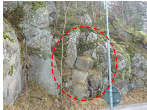
Foto 10. Block som bedöms kunna falla ut ner på vändzonen. Foto 11. Närbild av blocken
