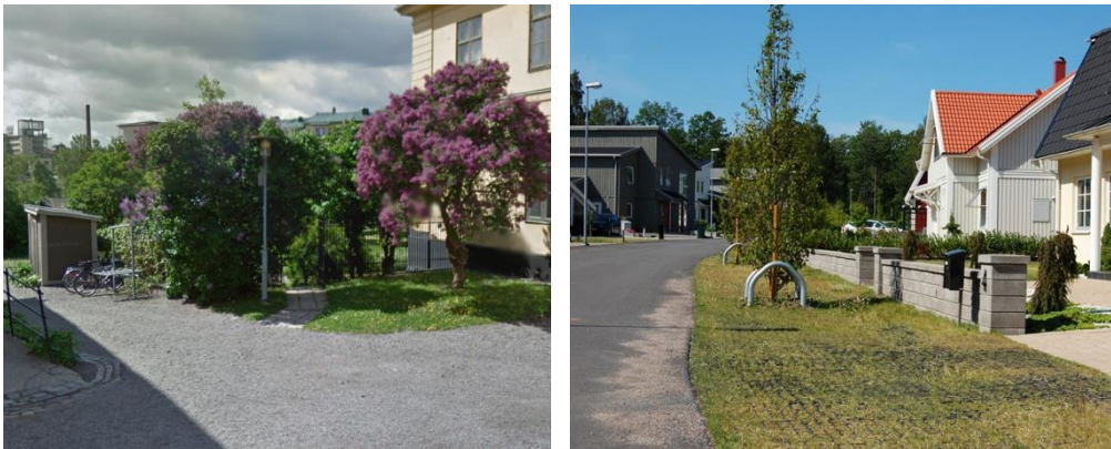
Figur 10. Grusad yta t.v. och gräsyta med pelleplattor (Vegtech) som förstärkning för att kunna köra på.
