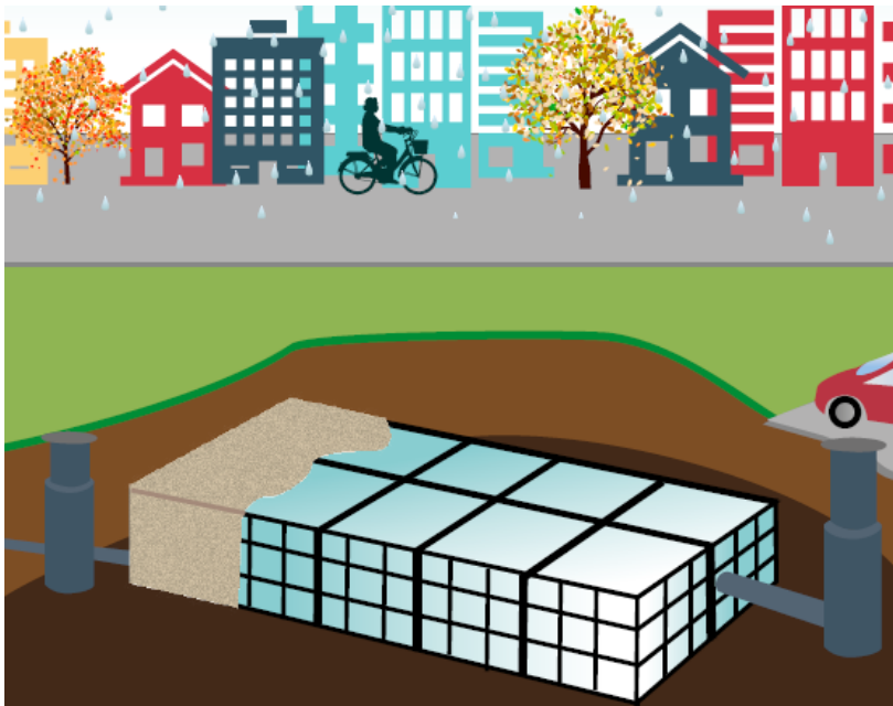
Figur 13. Kassettmagasin. Källa: Göteborg när det regnar.
