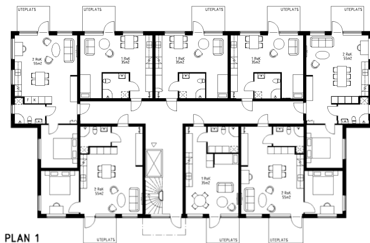
Figur 3. Planritning hus A, plan 1 (plan 2 har samma planlösning). Hus B har samma layout, bara spegelvänd.
