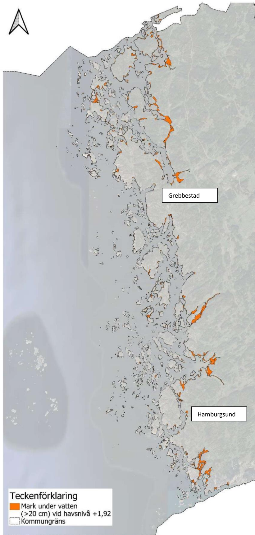
Figur 3. Översikt över kustområden där mark översvämmas med mer än 20 cm vid en havsnivå om +1,92 (RH2000), enligt den Scalgoanalys som har utförts i skyfallsanalysen. Kartbilden visar kommunens kustlinje. Hela kommunen har ingått i analysen.
